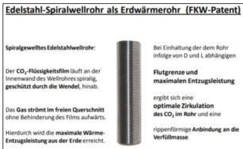
Abbildung 32: Edelstahl-Spiralwellrohr als Erdwärmerohr (Kruse et al., 2011)
