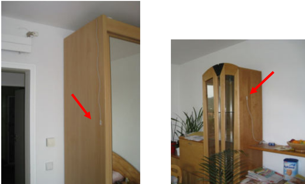
Abbildung 4: Positionen der Sensoren in der untersuchten Wohnung im Passivhaus Kammelpweg. Links: Schlafzimmer. Rechts: Wohnzimmer.
