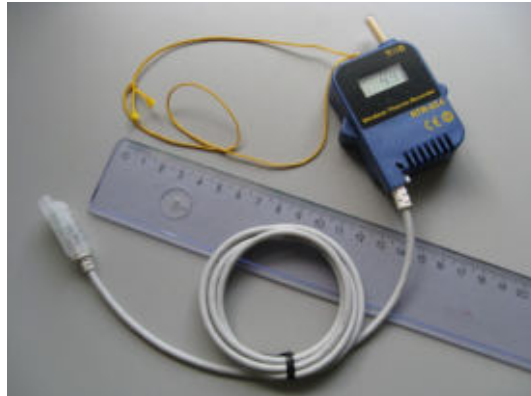
Abbildung 7: Für die Messungen verwendeter Temperatur- und Luftfeuchtigkeitssensor als auch Datenlogger RTR-53 (T&D Corporation, Japan).
