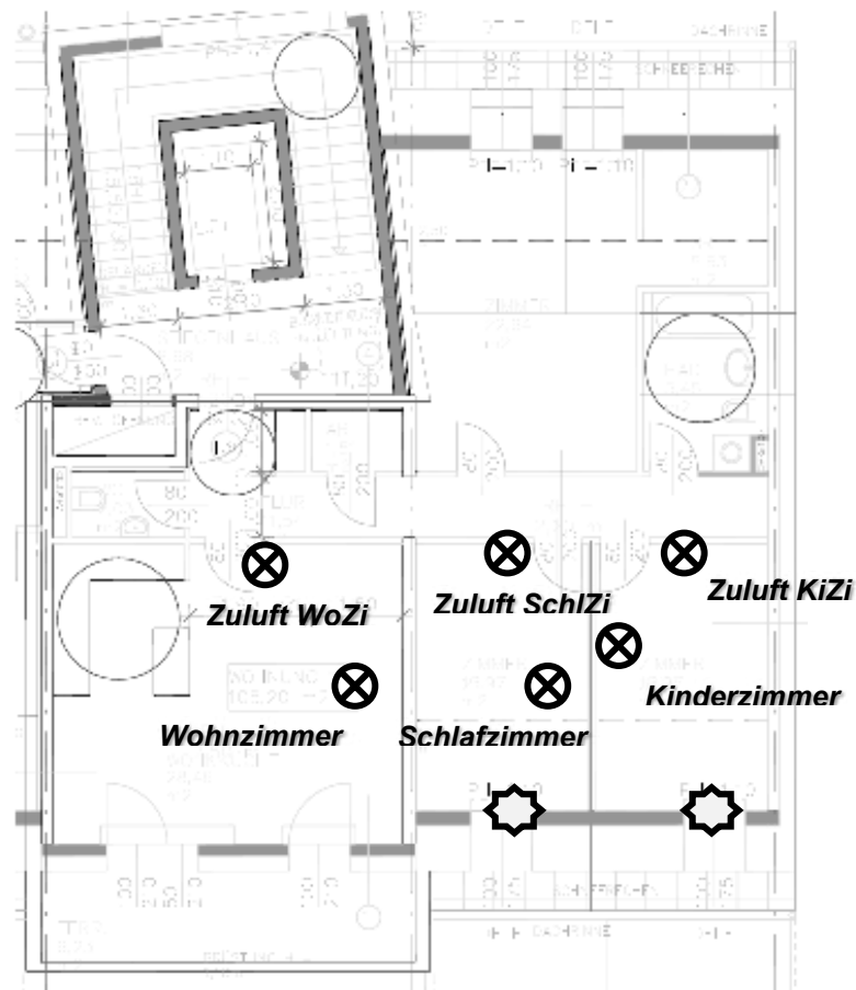
Abbildung 6: Planskizze der gemessenen Wohnung im Passivhaus Utendorfgasse mit Angabe der Positionen der Sensoren (Kreise mit Kreuz = Temperatur und Luftfeuchtigkeit, Acht-Stern = Fensteröffnung). Norden ist oben auf dem Bild.
