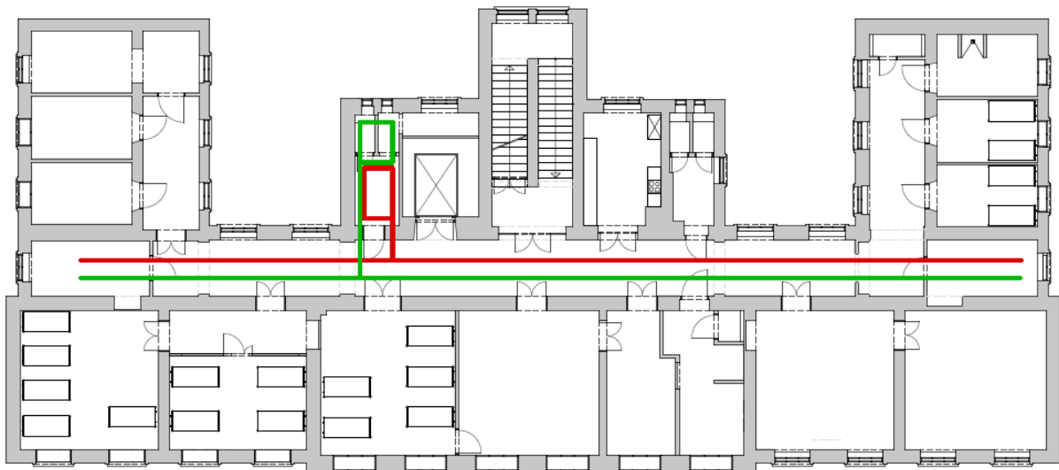
Abbildung 70: Pavillon 22, Ebene 3 - schematische Darstellung Verteilung von Zuluft und Abluft in abgehängter Gang-Zwischendecke
