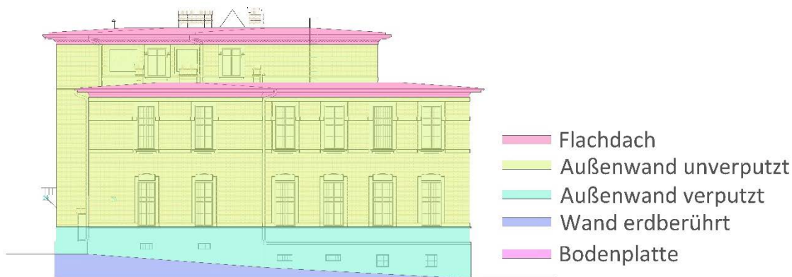
Abbildung 51: Ansicht eines Musterpavillons mit Kennzeichnung der Bauteile der thermischen Hülle (Quelle: Plan von KAV zur Verfügung gestellt, verändert durch Schöberl & Pöll GmbH)
