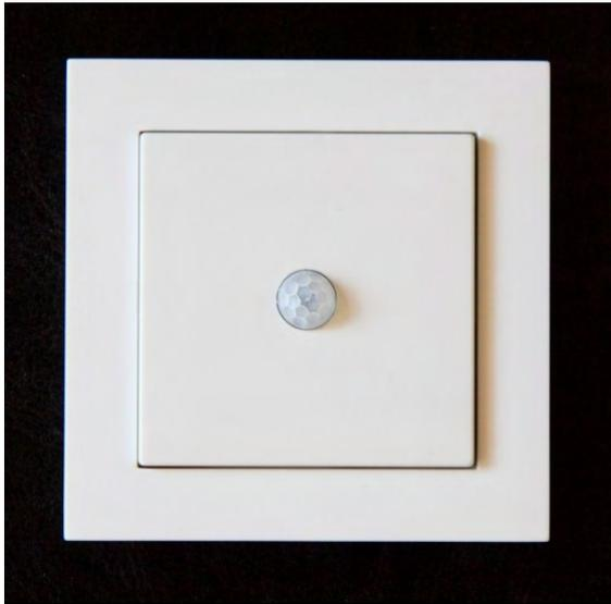
Abbildung 14: Fertiggestellter Präsenzmelder-Prototyp (Quelle: MachineVision Robert Mudri)
