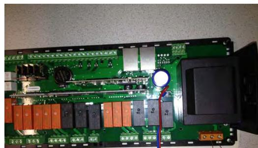
Abbildung 33: ecos500 Raumautomationsstation – Produktbild und modifizierte Variante (Quelle Produktbild: Sauter AG, Quelle Foto: Schöberl & Pöll GmbH, [PLUS14])
