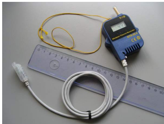
Abbildung 2: Für die Messungen verwendeter Temperatur- und Luftfeuchtigkeitssensor als auch Datenlogger RTR-53 (T&D Corporation). [TU Wien, Forschungsbereich für Bauphysik und Schallschutz]
