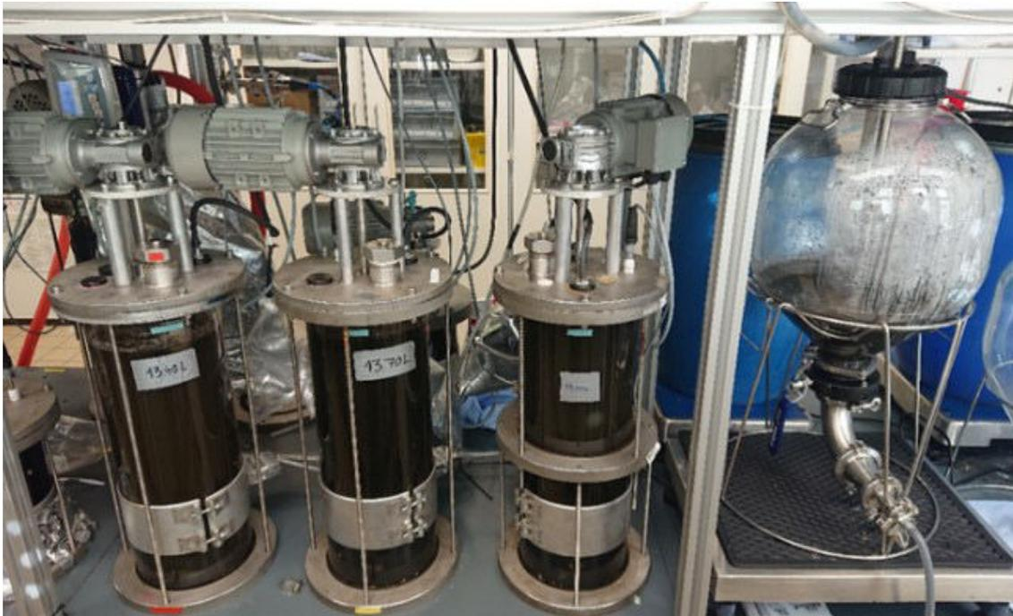
Abbildung 2: Die Biogas-Laboranlage im Betrieb. Rechts der Vorlage- bzw. Absetzbehälter, links die drei Fermenter, Materialfluss von rechts nach links (Bildnachweis: Institut für Umweltbiotechnologie, BOKU Wien)
