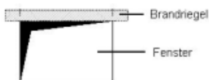
Abb. 28. Ansicht Fenster mit Brandriegel
