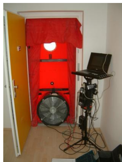
Abbildung 8: Messaufbau in der Praxis (Quelle: Leit-wolf Luftkomfort)
