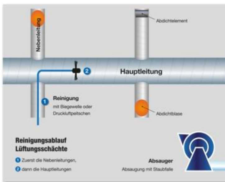
Abbildung 18: Prinzipschema einer Bürstenreinigung, Quelle: breg-rauchfangkehrer.at
