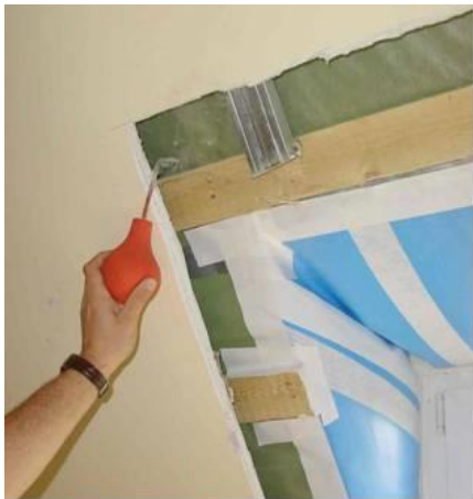
Abbildung 9: Lokalisieren von Lufteintritten mittels Handrücken oder Rauchröhrchen
